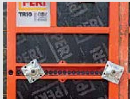
Многофункциональные панели TRIO, 72 см в ширину и с непрерывным рядом отверстий для сквозного соединения.
