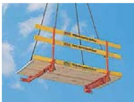
Платформа для бетонирования TRIO 120 x 270 поставляется уже в собранном виде. Она устанавливается сверху на элемент и автоматически закрепляется. Допустимая нагрузка - 150 кг/м<sup>2</sup>.
