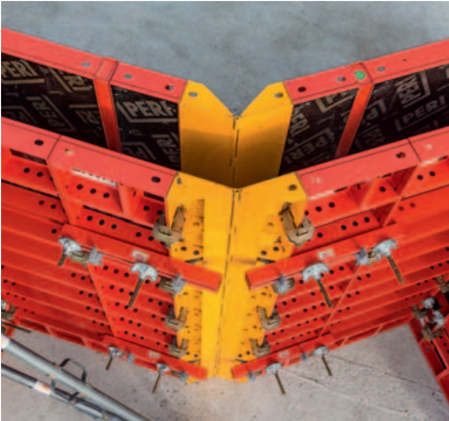
Шарнирный угол LIWA предназначен для опалубки не прямых углов от 75° до 165°. При этом на внешнем углу следует установить выравнивающий ригель.
