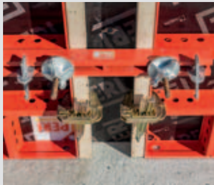
Выравнивающий ригель предназначен для устройства доборных вставок до 25 см с помощью брусков и фанеры.
